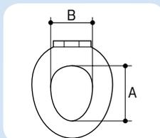
ご使用されている便座のA・Bの各寸法を測定し、取り付け可能かどうかを確認してください。
